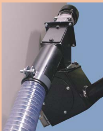
Flexibler Anschluss der Förderschnecke 180° drehbar
