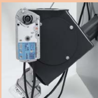
Rückbrandschutzeinrichtung Bei Stillstand, Stromausfall oder überhöhter Temperatur schließt die Rückbrandschutzklappe selbstständig
